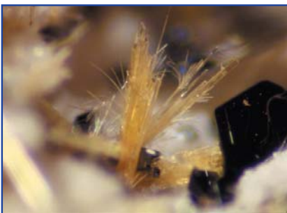
Tipi di cristalli di fluoro-edenite presenti nel materiale lavico usato per la costruzione di edifici, fondi stradali, ecc., visualizzati al microscopio.
